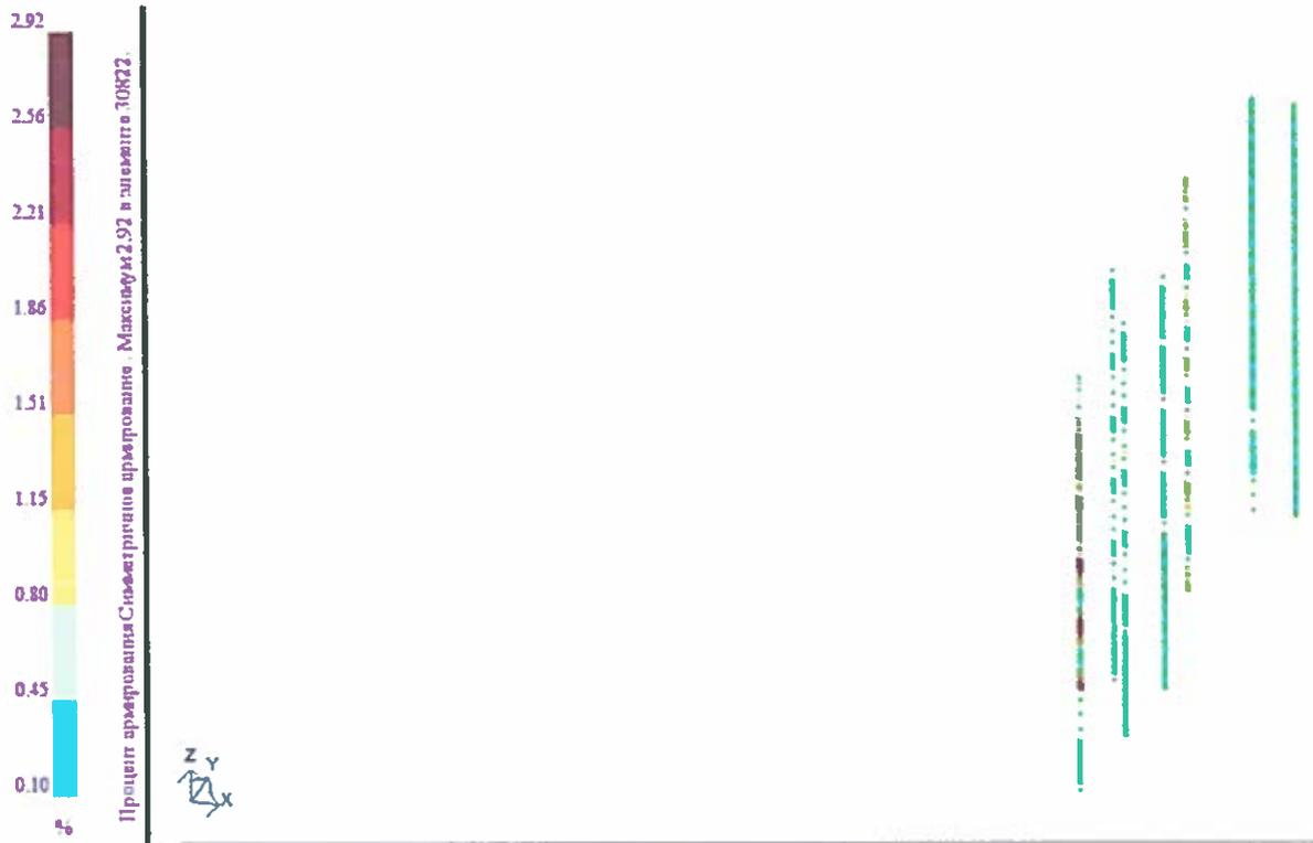
Рисунок 5.16 – Відсоток армування колон прямокутного перерізу з відмітки -1,0 до +15,0 в осях 1-3/А-М
